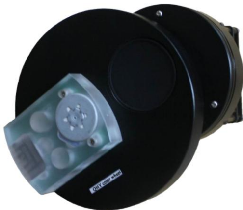
Рис. 1. Астрономическая ПЗС камера QHY9 вместе с автофотометром QHY Color wheel
